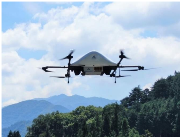
特許技術「4D GRAVITY®」を搭載した物流専用ドローン
